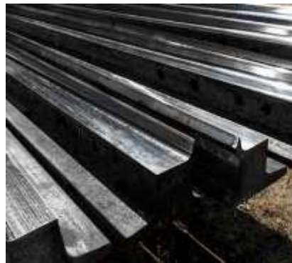
Компоненти стрілочних переводів
