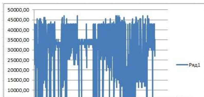
Рис.2 Залежність прискорень колії від часу при частоті 27 Гц
