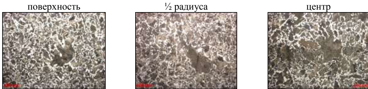
Рисунок – Микроструктура черновой оси Ø 220 мм, × 200. Сталь марки ОС
