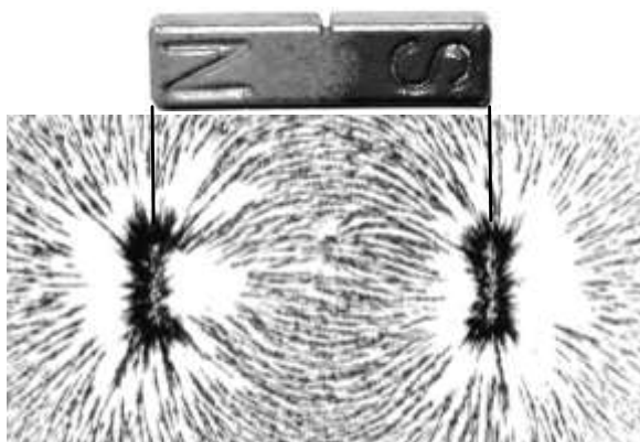
Рис. 2. Силовые линии магнитного поля магнита с поперечным дефектом
